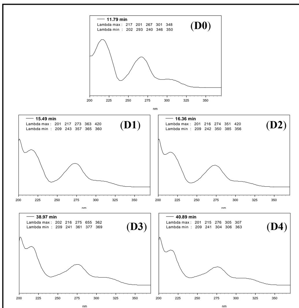
**Figura 4.62.** Espectros de UV das bandas cromatográficas selecionadas
