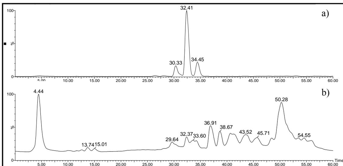
**Figura 4.75.** a) Cromatograma de íons selecionados para  $m/z$  451; b) cromatograma de íons totais do extrato do cultivo de FG1 em arroz
