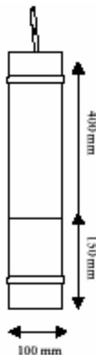
**FIGURA 1.** Silo de laboratório para avaliação das silagens.
