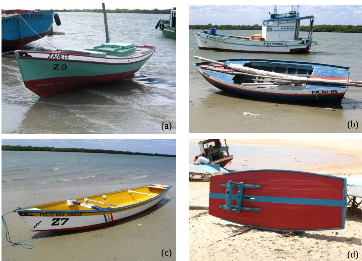
Figura 12 - Composição da frota da pesca pequena escala no litoral setentrional do Rio Grande do Norte. Bote à vela com convés (a) e sem convés (b); canoa a remo (c) e paquete à vela (d).
