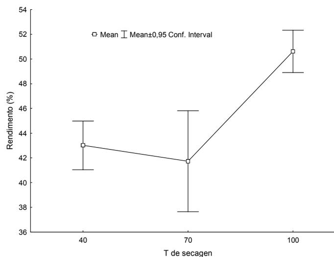
Figura 16- Rendimentos médios e intervalos de confiança construídos com 95% de certeza, para a extração de óleo de sementes de andiroba em diferentes tratamentos de temperatura de secagem (40, 70 e 100°C).
