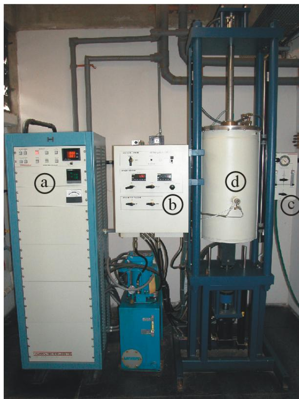
Figura 2.4: Prensa Thermal Inc utilizada em processos de sinterização assistidos por pressão. Podemos observar em (a) o controlador de temperatura do forno resistivo (d) onde é disposta a amostra. Em (b) observamos o controlador da carga aplicada sobre a amostra durante o processo de sinterização. E em (c) o dispositivo utilizado para controle da atmosfera dentro do forno.
