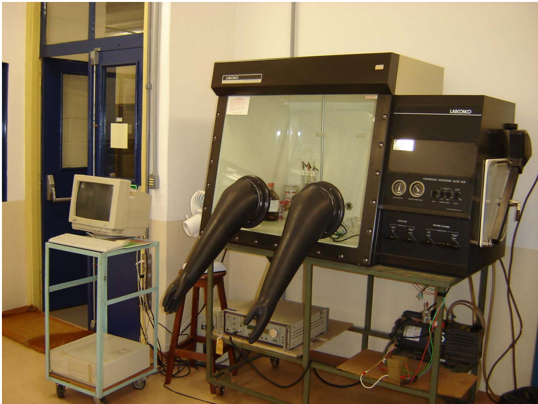
FIGURA 2.7 – Câmara de atmosfera controlada utilizada nos experimentos de carga/descarga.
