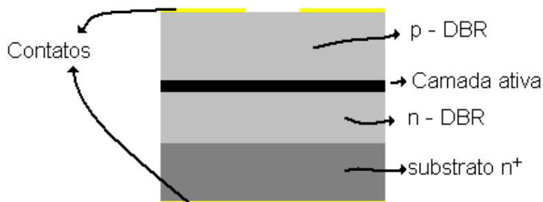
Figura 2-1 Estrutura básica de um dispositivo VCSEL.
