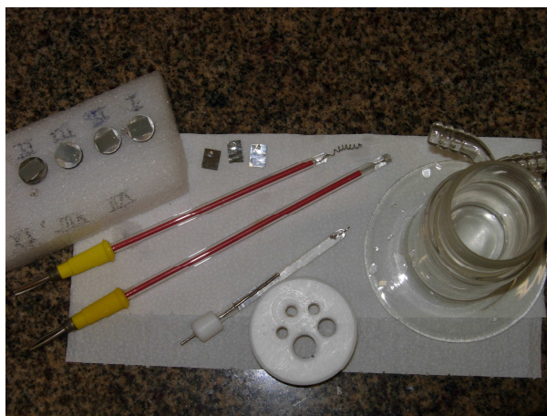
FIGURA 2.1 – Fotografia da célula eletroquímica e dos eletrodos utilizados.
