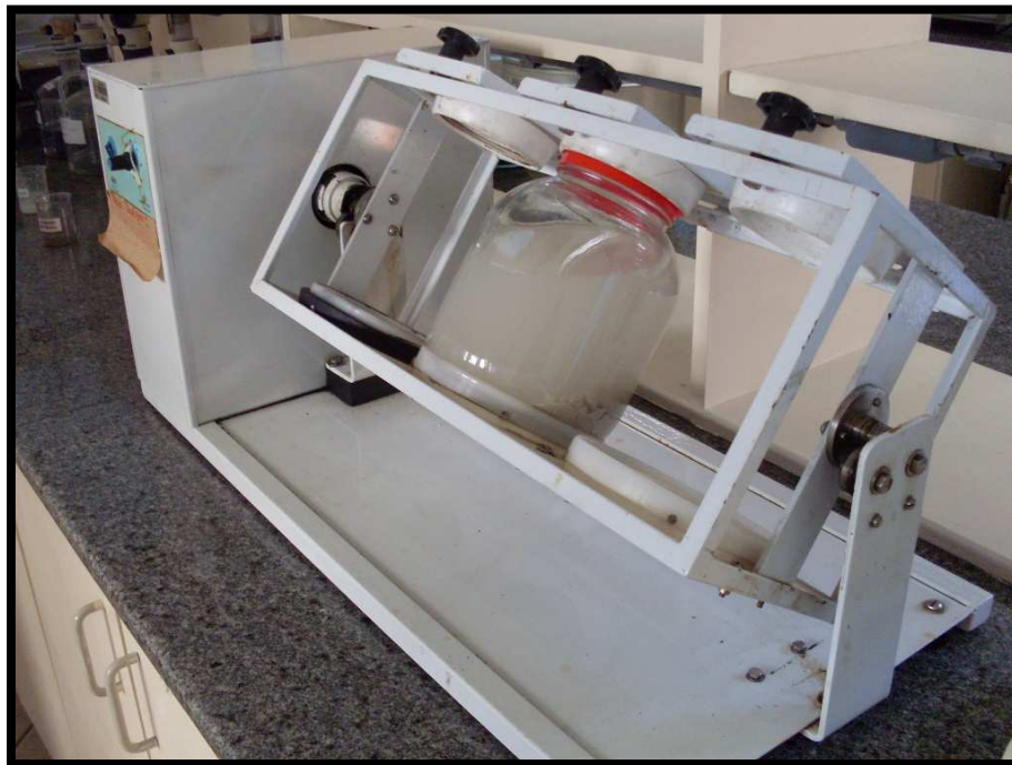
Figura 14 - Lixiviação das amostras de lodo.
