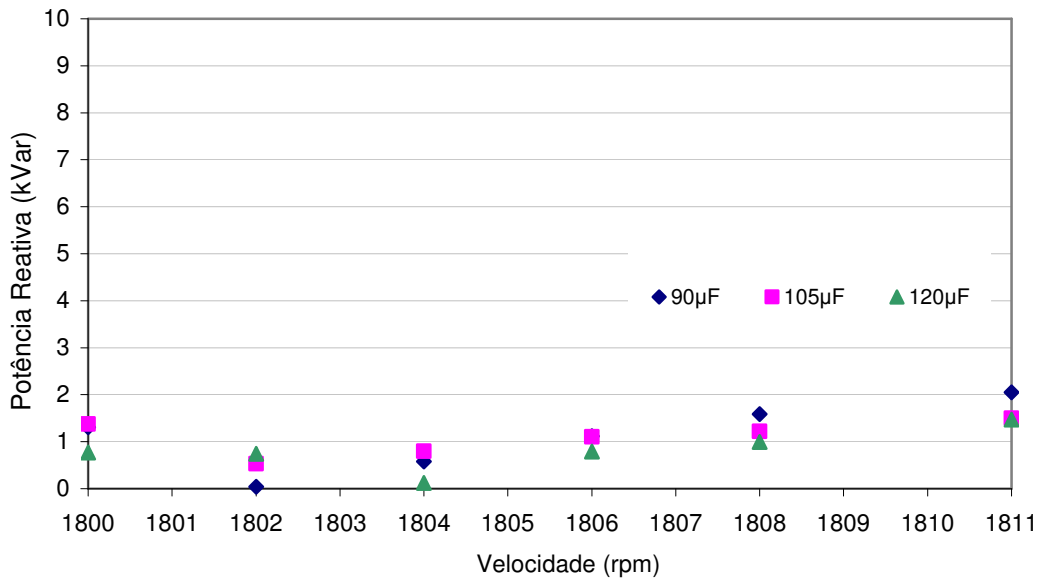
Figura 59 – Potência reativa trifásica dos valores medidos para banco de capacitores com capacitâncias de 90 μF, 105 μF e 120 μF ligados em paralelo ao gerador de indução.
