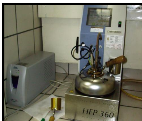
Figura 37 - Analisador do ponto de fulgor.
