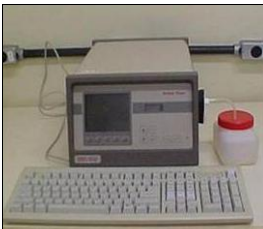
Figura 36 - Densímetro de bancada Anton Paar.
