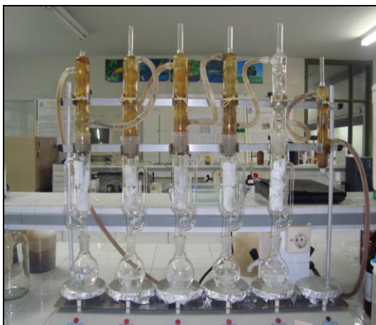
Figura 26 – Sementes acondicionadas no Soxhlet.
