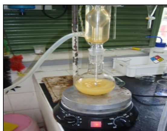
Figura 6C: Processo de esterificação do óleo de pinhão manso.
