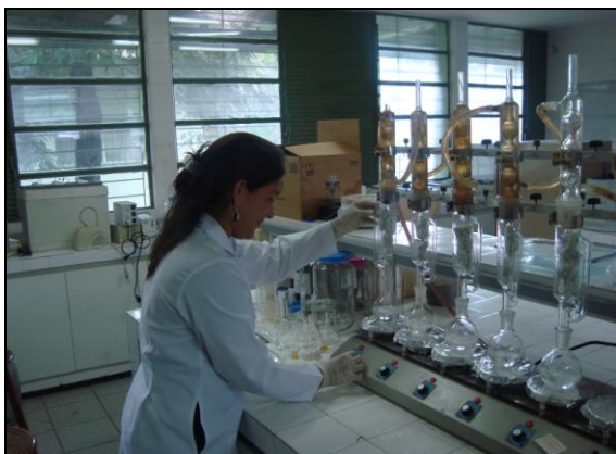
Figura 3C: Processo de extração no Soxhlet.
