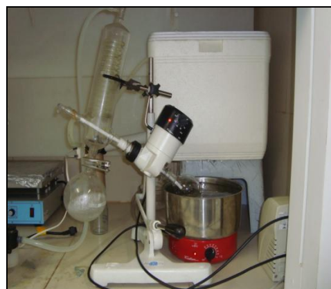
Figura 4C: Rotovaporador para recuperação do solvente.
