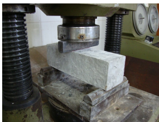
Figura 23: execução do ensaio de resistência à tração na flexão
