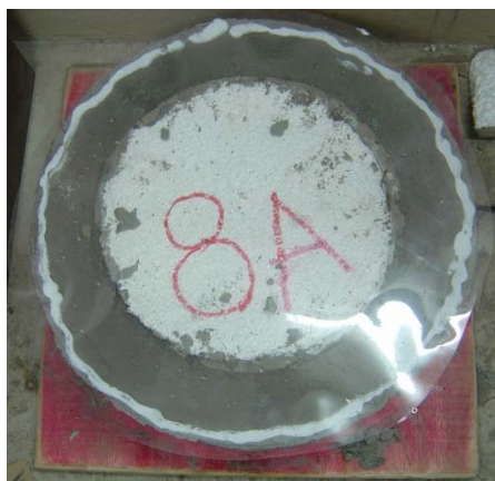
Figura 42: processo de secagem dos corpos-de-prova correspondentes ao ensaio de retração por secagem restringida
