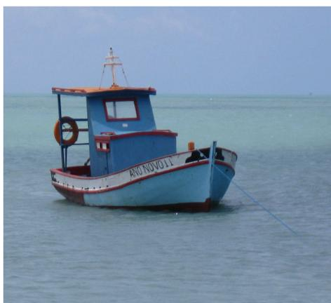
**Foto 3.3:** Barco tradicional de pesca a motor tipo - **bote** – de médio porte construído em madeira, utilizado para locomoção nos canais de maré como também no mar paralelo à linha de costa. Foto: Bruno Costa. (2008).
