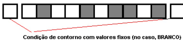
Figura 2.9 - Esquema de um autômato unidimensional com raio de vizinhança 1 e condição de contorno de limite de valores fixos.
