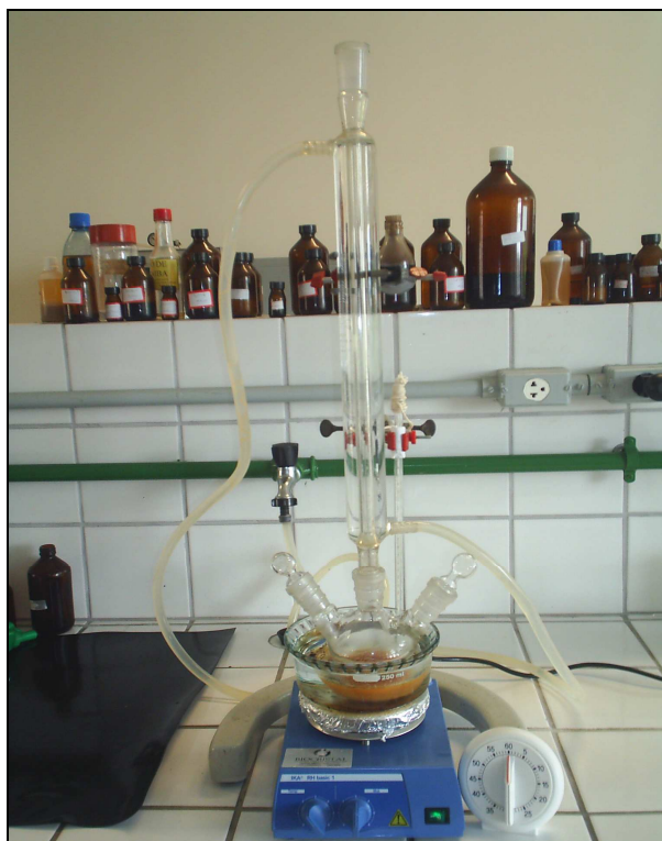
FIG 4.2 – Sistema para reações a temperatura de refluxo.
