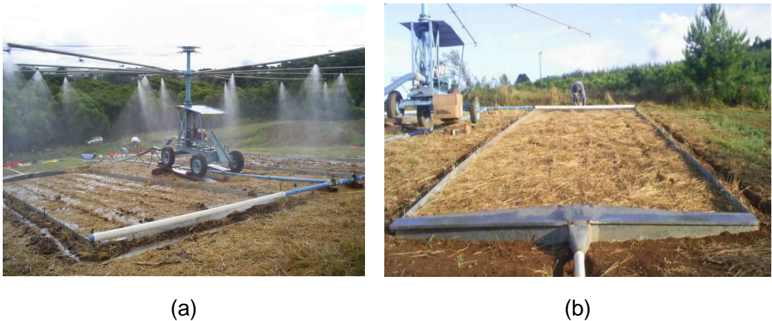
FIGURA 2. Vista do aparelho simulador de chuva concomitantemente aspergindo água em duas unidades experimentais (a) e de uma delas evidenciando o resíduo cultural de milho uniformemente espalhado na superfície do solo antes da aplicação da chuva (b).
