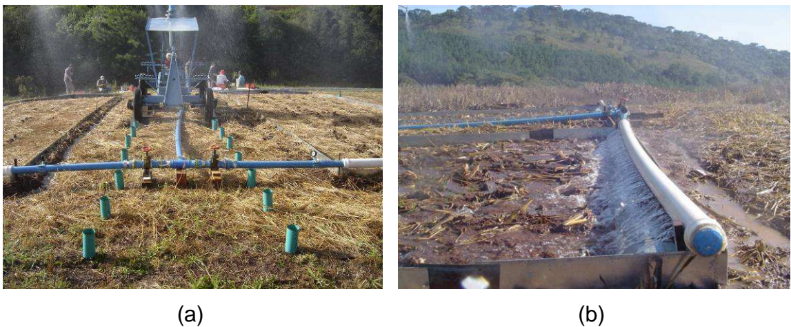
FIGURA 3. Vista de detalhes na operacionalização dos testes de erosão do Estudo 2: (a) pluviômetros sob a área de projeção de água do aparelho simulador de chuva para verificação da intensidade desta última e equipamento utilizado na adição dos fluxos extras de água - canos plásticos, registros de entrada e saída de água e manômetros - e (b) entrada de água na cabeceira de uma unidade experimental em um dos níveis de fluxo extra de água adicionados.
