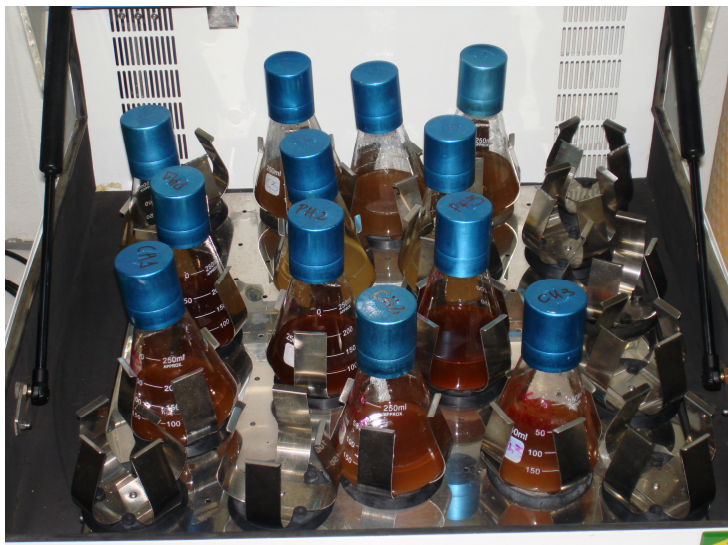
Figura 7 - Fermentação em agitador orbital da LOGEN.
