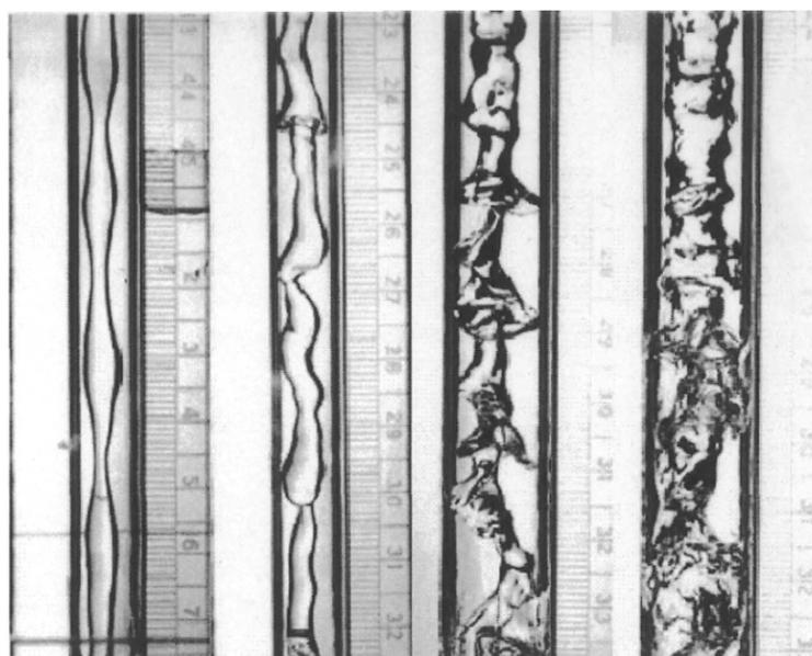
Figura 1.10 – Escoamento anular água e ar (ISHII; HIBIKI, 2006).
