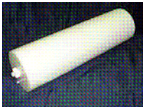
Figura 15 - Simulador NEMA para testes de espalhamento [www. biodex.com]
