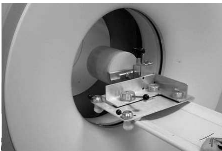
Figura 14 - Teste de Normalização: simulador homogêneo de atividade conhecida colocado no centro de visão do equipamento para aquisição [foto cedida].
