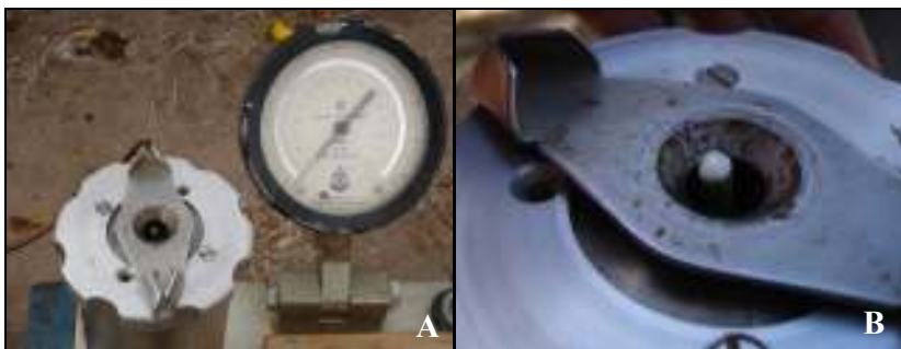
Figura 3. Câmara de pressão e manômetro da bomba Scholander (A); Exudação de seiva do ramo para medição do potencial hídrico (B).
