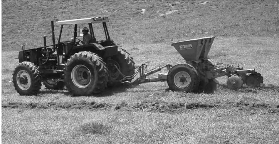
Figura 5 – Imagem do trator analisado, potência 150 cv, tração 4 x 2 auxiliar TDA, tracionando o subsolador-adubador de arrasto.
