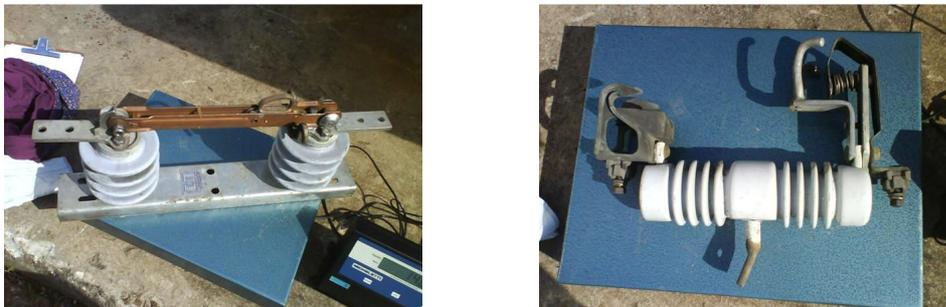
**Figura 22** – Chaves cuja parte isoladora é feita de porcelana cinza: (a) faca, (b) fusível.
