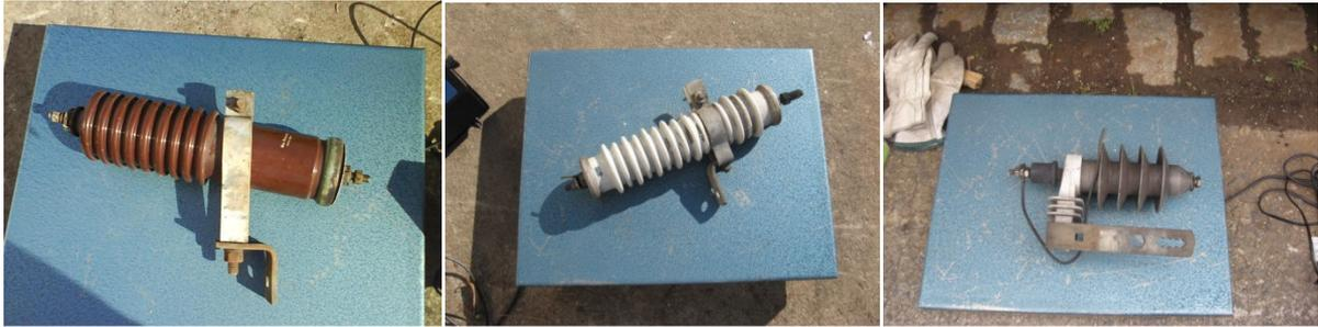
**Figura 23** – Exemplos de para-raios encontrados: (a) parte isoladora feita de porcelana marrom, (b) parte isoladora feita de porcelana cinza, (c) parte isoladora feita de polímero.
