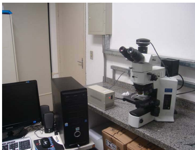
Figura 18 - Microscópio Óptico utilizado para a realização da caracterização microestrutural.
