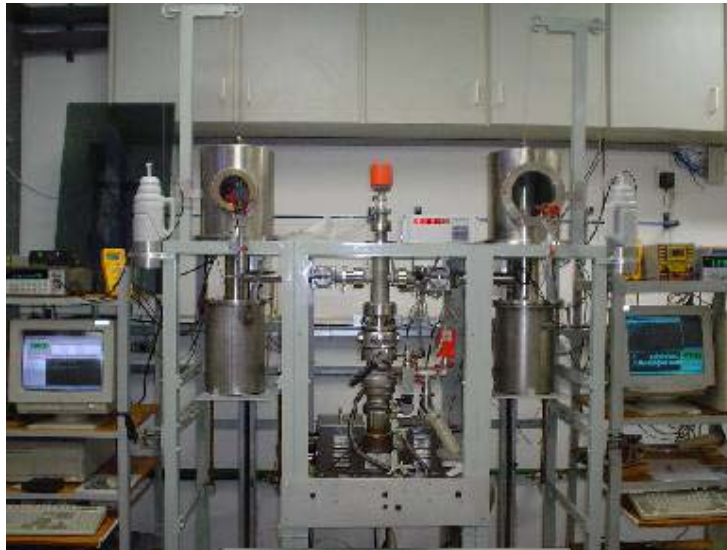
Figura 19(b) - Fotografia do sistema de medidas de Espectroscopia Mecânica.
