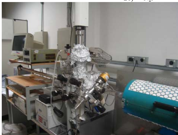
Figura 12 - Diagrama esquemático (a) e fotografia (b) do Sistema de Tratamentos Térmicos do Laboratório de Anelasticidade e Biomateriais da UNESP/Bauru.
