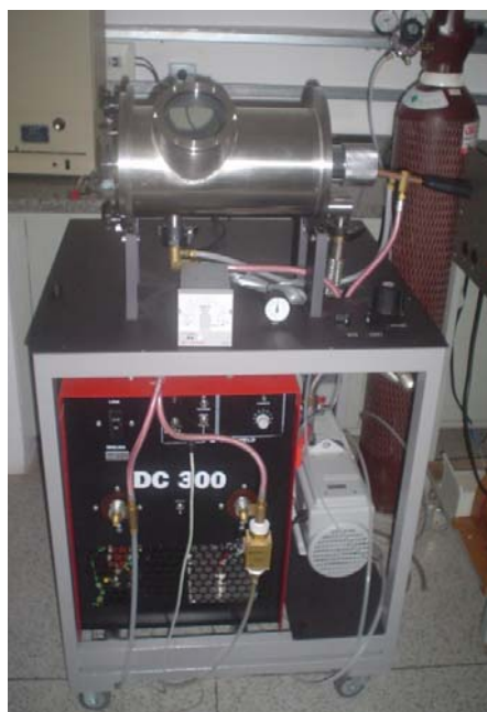
Figura 9 – Forno de fusão à arco voltaico utilizado na fusão das amostras.
