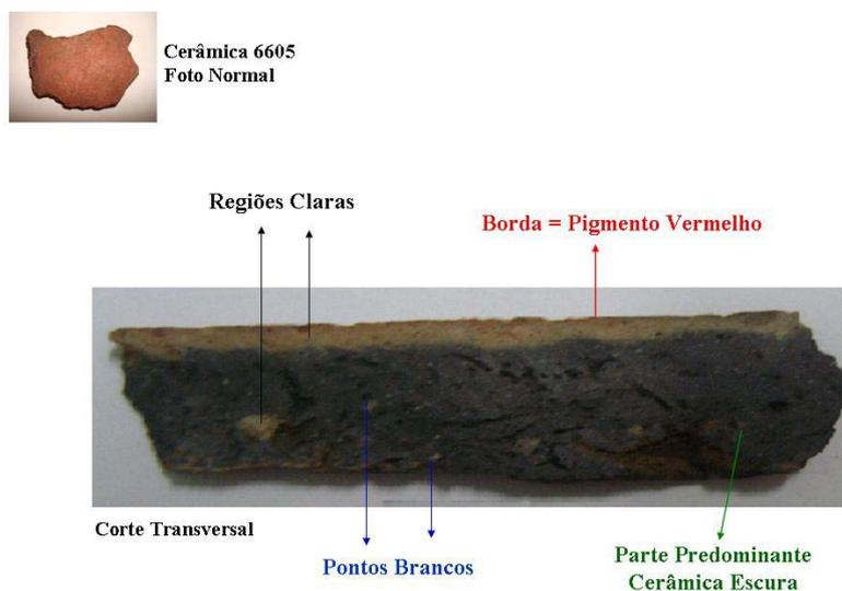
**Figura 6:** corte transversal da cerâmica 6605.
