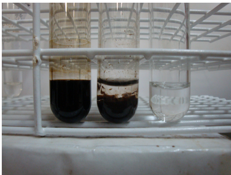
Figura 3.2. Soluções utilizadas no experimento. Da esquerda para a direita: o tubo 1 com a dispersão de EDL-MF a 1%, o tubo 2 com a dispersão de EDL-MF na presença de TMANO3 0,6 mol/L e o tubo 3 com a solução de TMANO3 a 0,6 mol/L.
