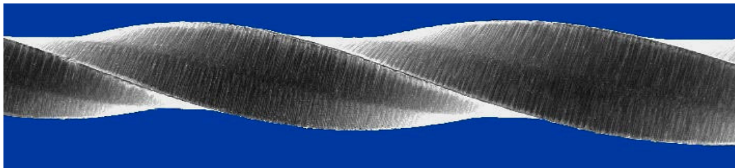
Figura 21 - Imagem de eletromicrografia equivalente ao escore 1 com relação ao critério de perda de metal.
