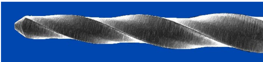
Figura 18 - Imagem de eletromicrografia equivalente ao escore 1 com relação ao critério de distorção das espiras.
