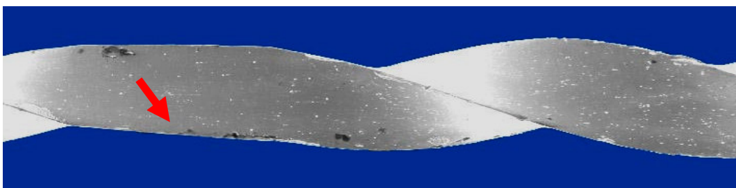
Figura 19 - Imagem de eletromicrografia equivalente ao escore 2 com relação ao critério de distorção das espiras (*).
