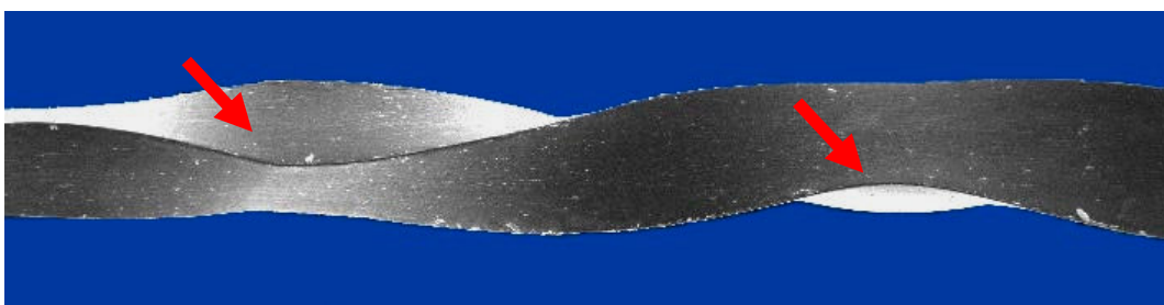
Figura 20 - Imagem de eletromicrografia equivalente ao escore 3 com relação ao critério de distorção das espiras (*).
