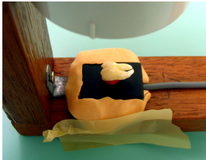
Figura 04 - Imagem do dente posicionado sobre o sensor radiográfico digital.
