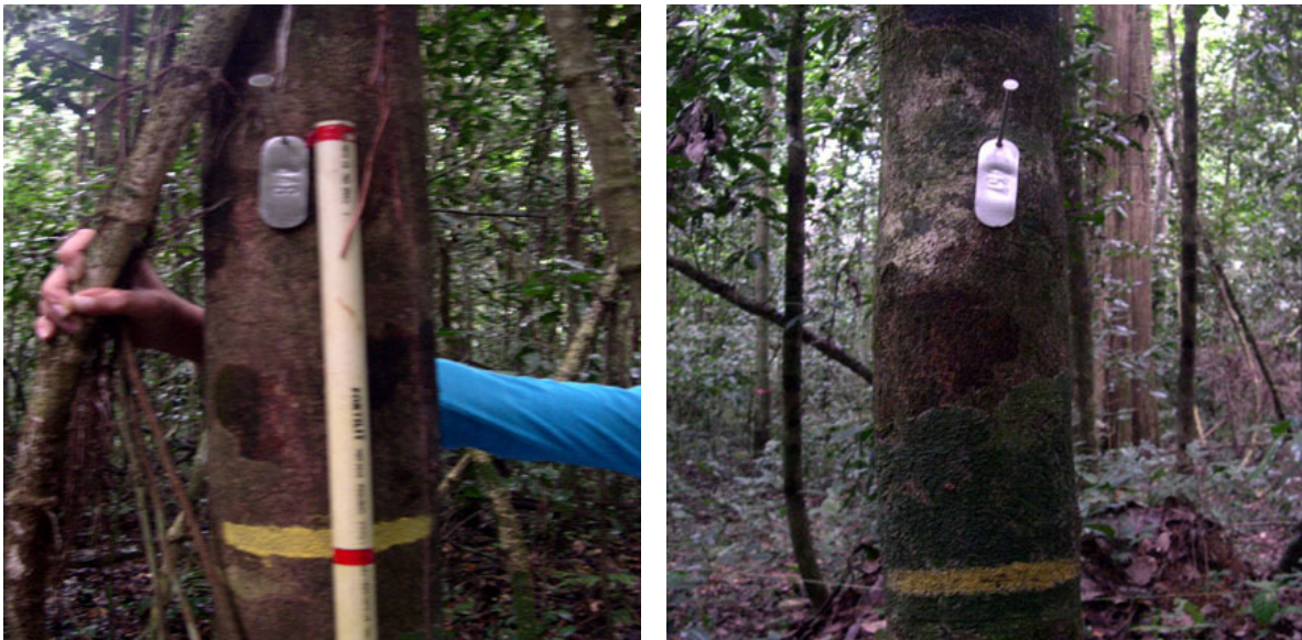
FIGURA 3: Detalhe da marcação das árvores: Tubo de PVC graduado, tinta (POM a 1,30 m), prego e placa (1,60 m).
