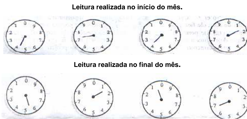
FIGURA 26: ESQUEMA DE UM MEDIDOR ANALÓGICO DE CONSUMO ELÉTRICO.
