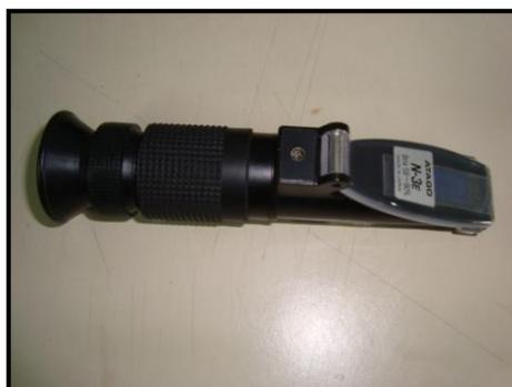
**Figura 8.** Refratômetro utilizado na determinação do índice de refração.
