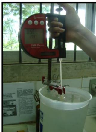
**Figura 10.** Sistema para determinação da massa específica.
