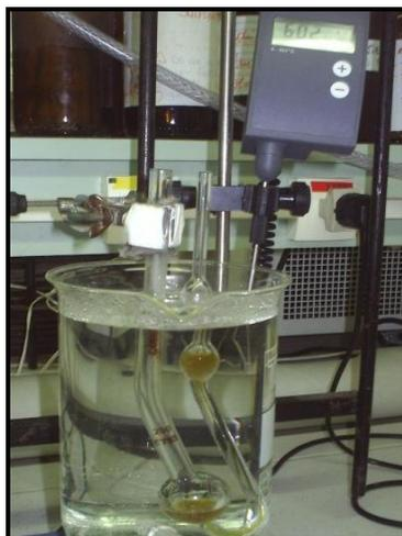
**Figura 9.** Sistema para determinação da Viscosidade.
