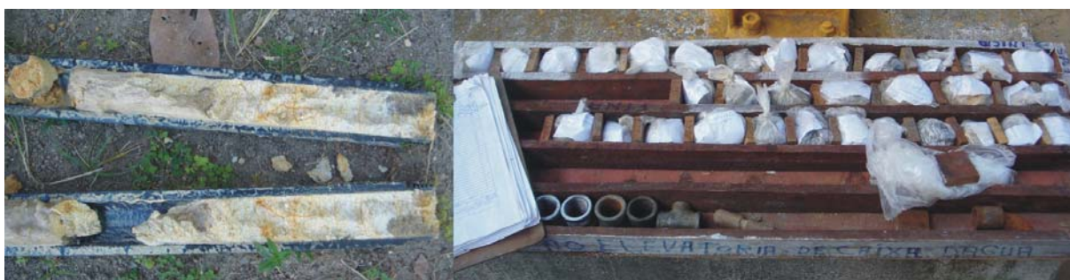
Figura 5.15 - Amostrador e caixa de amostragem dos furos de sondagem / SPT.
