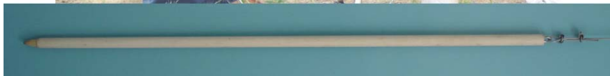
Figura 5.25 - Colocação do dispositivo para produzir a variação de nível d'água no piezômetro SP4 (superior), e detalhe do dispositivo (inferior).
