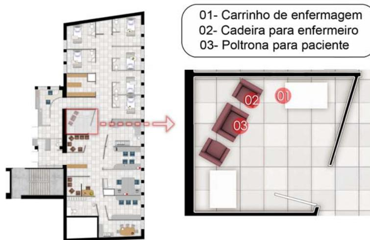
FIGURA 92 – Planta estudo de viabilidade do ambiente de coleta de sangue
