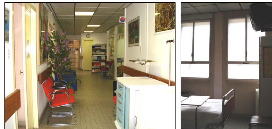
FIGURA 27 – Piso cerâmico, forro de gesso removível, luminárias embutidas e janelas do hospital-dia VIH – 1º pavimento.
