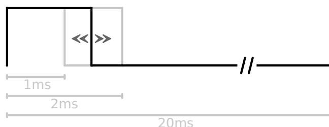
Figura 2.10: Sinal de PWM gerado pelo rádio receptor para alimentar a entrada de sinal de um servo-motor ou ESC.
