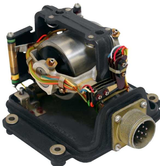
Figura 2.11: Giroscópio mecânico de massa girante desencapsulado.
