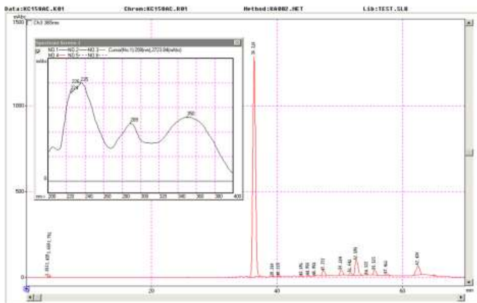
Figura 47 - Cromatograma da co-injeção da amostra KCW158 com a partição em Acetato de Etila - 365 nm
