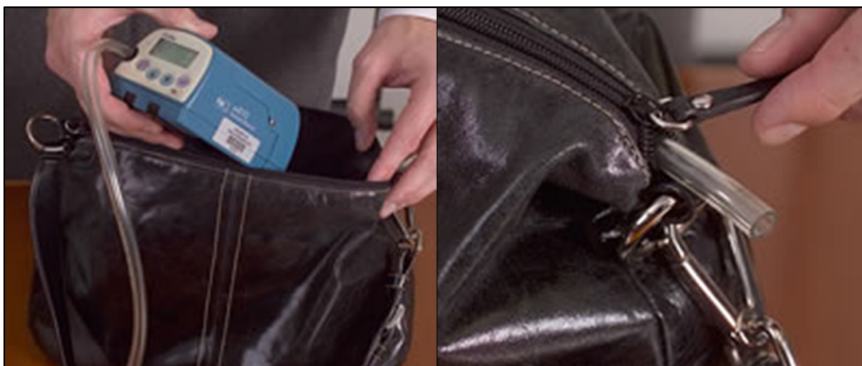
Figura 5.2 — Monitor para coleta de partículas finas [RPCI, 2008]
