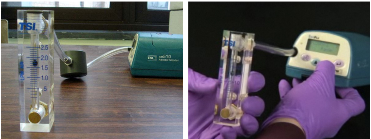
Figura 5.14 — Calibração da vazão: maneira inadequada e maneira mais adequada de uso do rotâmetro [RPCI, 2008; JHSPH, 2009d]
