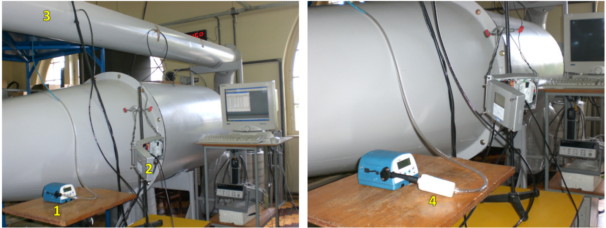
Figura 5.11 — Ensaio na bancada (1 monitor, 2 transmissor de T e UR, 3 pontos de aquisição, 4 monitor com filtro auxiliar)
