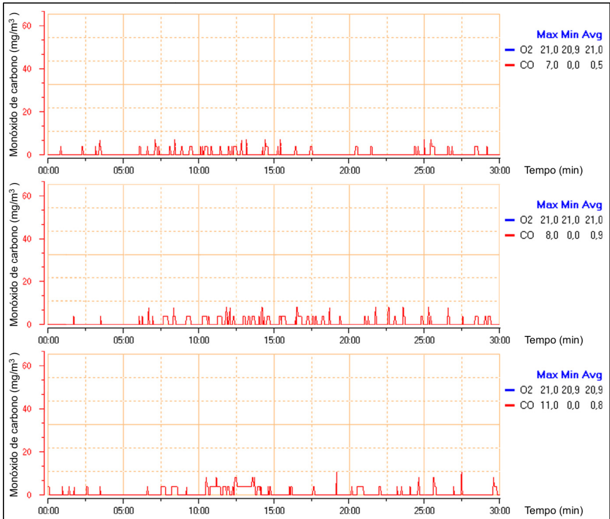
Figura 4.18 — Curvas de monóxido de carbono da área para não-fumantes do modelo, com barreira de separação
