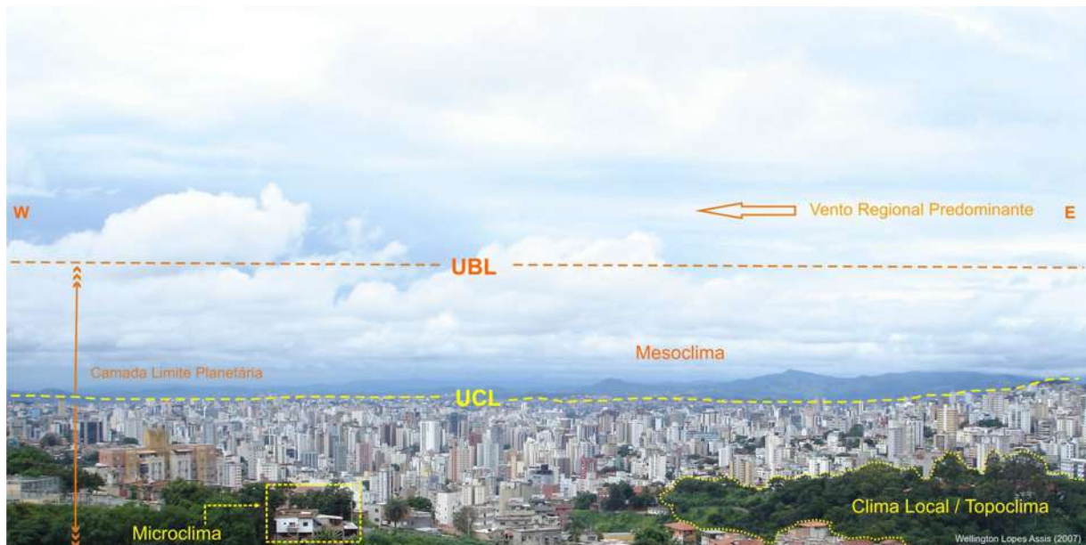
FIGURA 1: Representação esquemática da atmosfera urbana, adaptada de Oke (1978 e 2004). As dimensões horizontais e verticais das unidades climáticas são variáveis nesta perspectiva.
