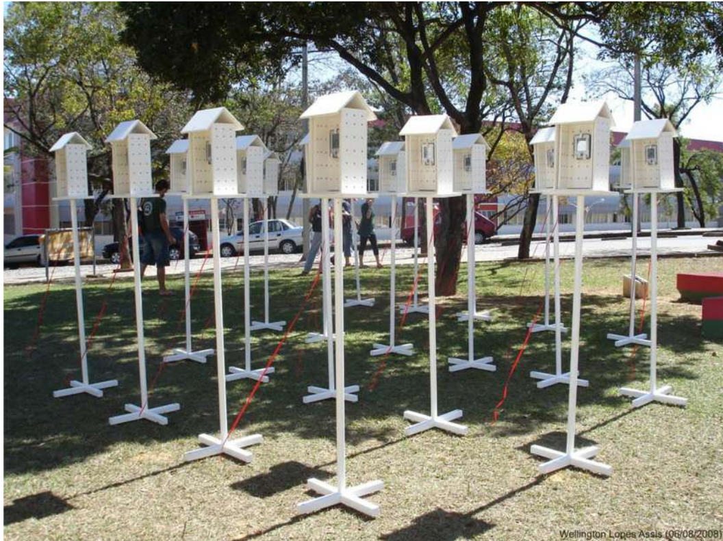
FIGURA 20: Terceira aferição dos termo-higrômetros datalogger TFA no Instituto de Geociências da UFMG.
