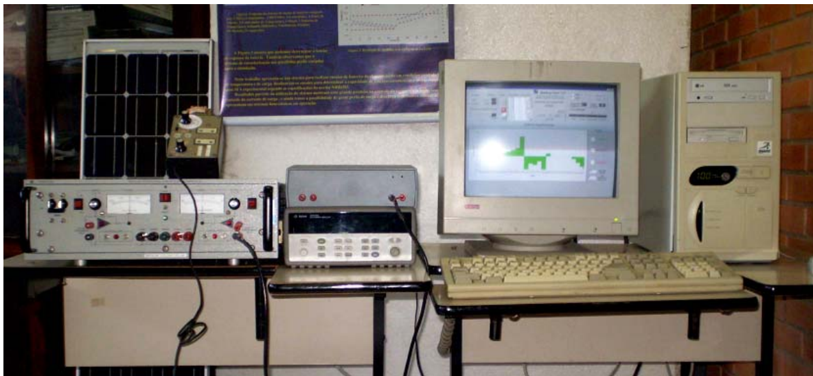
Figura 4.7 Alguns dos elementos utilizados para desenvolver o sistema de caracterização de baterias e computador que na tela do monitor apresenta o entorno gráfico do programa para controlar os ensaios.
