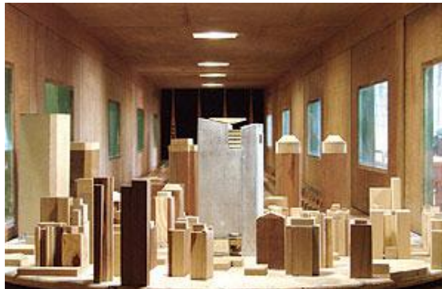
Figura 17 – Modelo rígido: ensaio de edifício e entorno.
