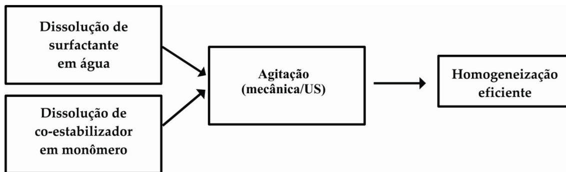
Figura 2.4: Esquema representativo para a preparação de uma miniemulsão.
