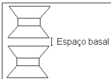
Figura 6 - Representação esquemática da estrutura cristalina das esmectitas. Figura adaptada (CHAGAS, 2005)
