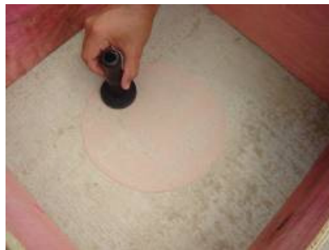
Conclusão do espalhamento
