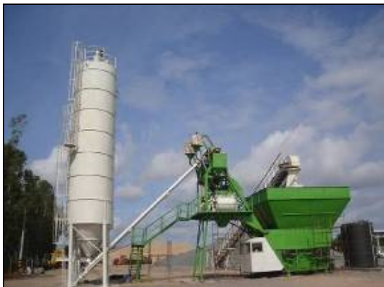
FIGURA 3 - EXEMPLO DE CENTRAL DOSADORA E MISTURADORA DE CONCRETO FOTO: FRANCELINO, M.J.M. Schwing Stteter M2. 2007. 1 foto digital
