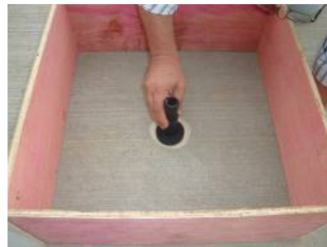
Início do espalhamento da areia
