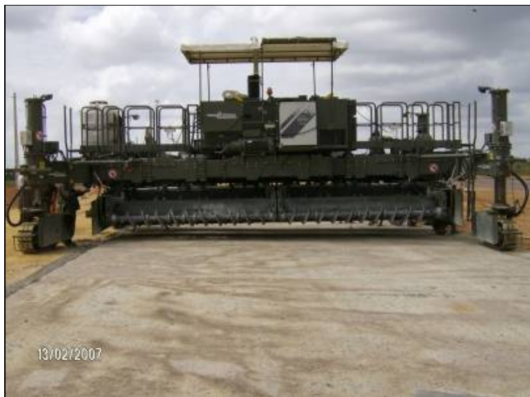
FIGURA 5 – EXEMPLO DE EQUIPAMENTO DE FORMAS DESLIZANTES FOTO: FRANCELINO, M,J,M. Wirtgen - SP-850. 2007. 1 foto digital
