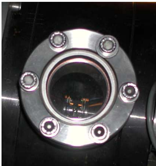
Figura 13: Foto da região de ionização, eletrodos e parte do eletroímã.
