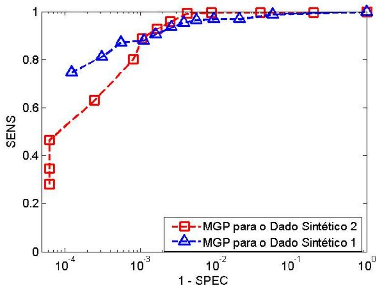
Figura 17: Para os Dados Sintéticos 1 e 2, foram construídas curvas ROC parametrizadas, para o método MGP pelo limiar na probabilidade posterior. Os níveis de ruído usados  $\sigma = 6$ . Área ROC para o dado sintético 1 igual a 0,9978 e para o dado sintético 2, 0,9986. Note o eixo horizontal logarítmico.
