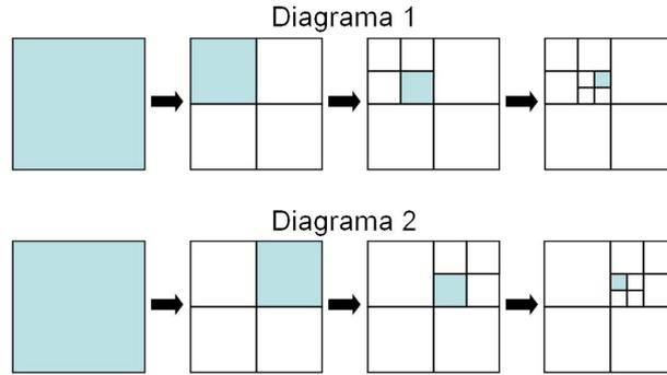
Figura 15: Diagramas do método MGP para um exemplo de imagem de  $(8 \times 8)$  pixels. Da esquerda para direita, tem-se uma seqüência de índices  $q = 3, 2, 1, 0$ . Em destaque, regiões  $B_{p^q}$  que representam a influência espacial sobre os dois 0–pixel vizinhos destacados à direita.
