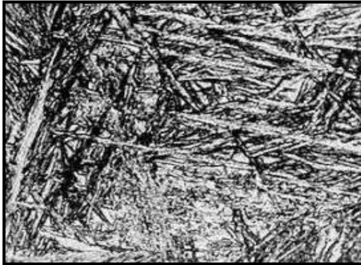
Figura 2.9 – Imagem ilustrativa de uma microestrutura da metaestável, a martensita. Fonte: material didático Nascimento, 2003/2004.
