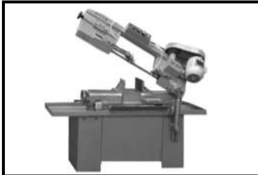
Figura 3.3 - Máquina serra de fita para corte vertical e horizontal de materiais.
