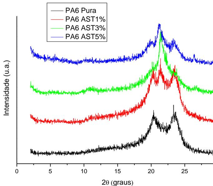
Figura 23: Difratogramas dos filmes poliméricos para a PA6 pura e seus nanocompósitos com AST nas proporções de 1, 3 e 5% em peso de argila
