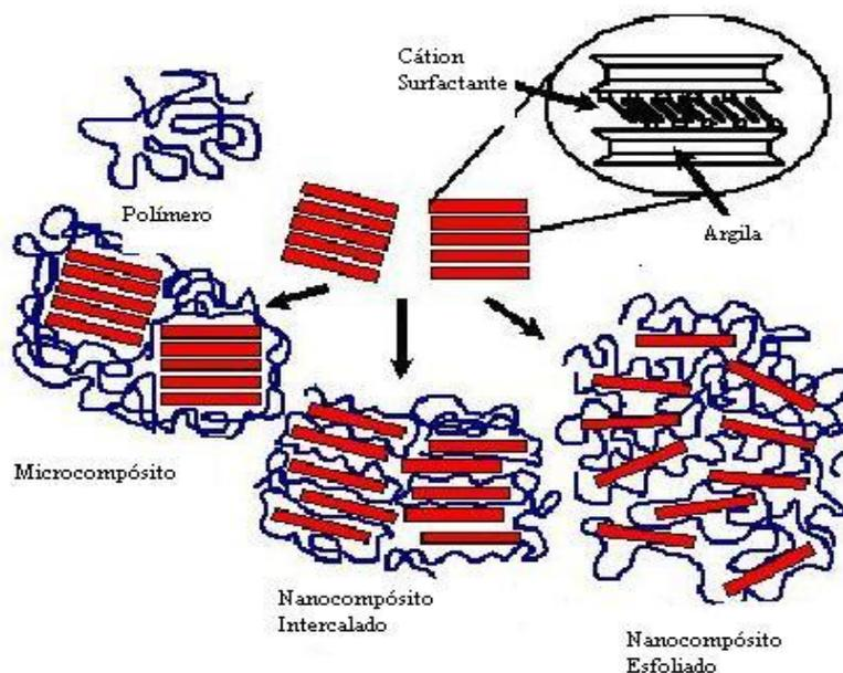
Figura 4: Representação esquemática dos tipos de estruturas de compósitos
