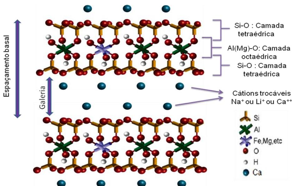
Figura 6: Representação esquemática da estrutura da montmorilonita
