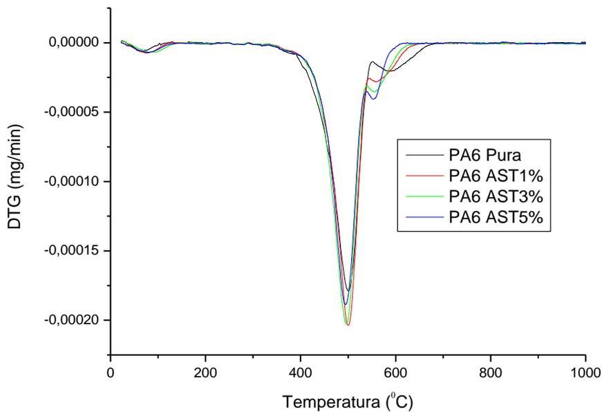
Figura 29: Curvas DTG dos filmes poliméricos para a PA6 pura e seus nanocompósitos com AST nas proporções de 1, 3 e 5% em peso de argila
