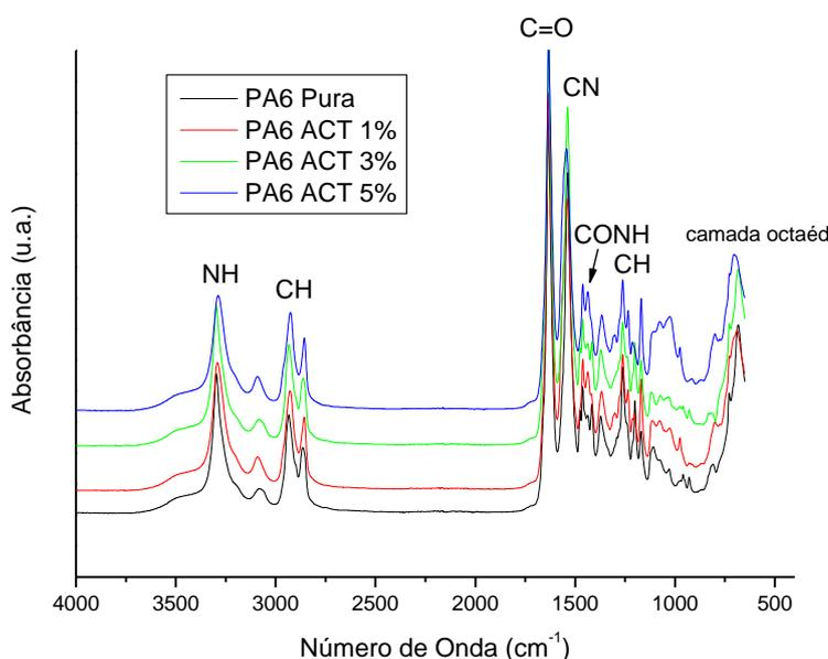
Figura 26: Espectros de FTIR dos filmes poliméricos da PA6 pura e seus nanocompósitos com ACT nas proporções de 1, 3 e 5% em peso de argila
