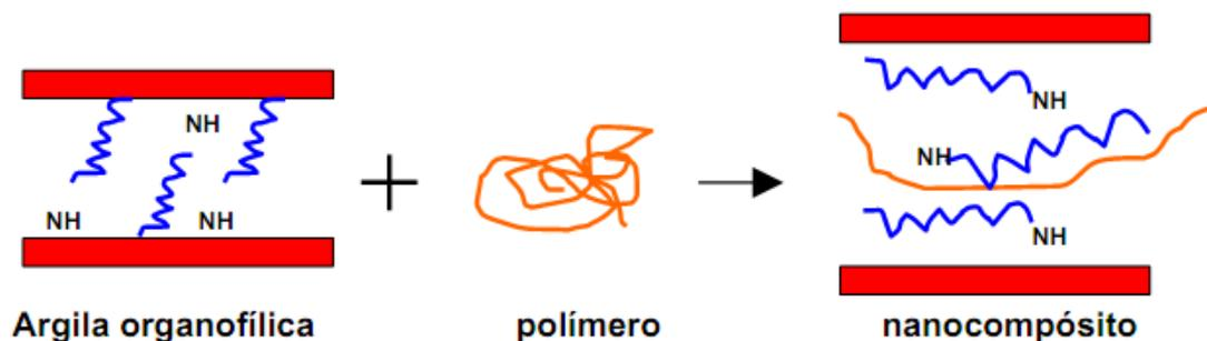
Figura 3: Processo de obtenção de nanocompósitos por fusão
