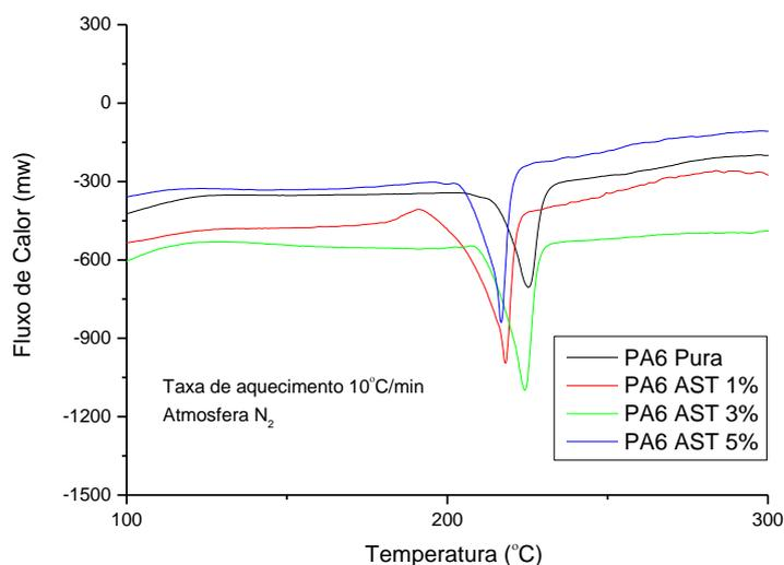
Figura 31: Curvas DSC dos filmes poliméricos para a PA6 pura e seus nanocompósitos com AST nas proporções de 1, 3 e 5% em peso de argila
