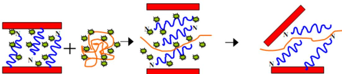
Figura 1: Processo de obtenção de nanocompósitos por solução
