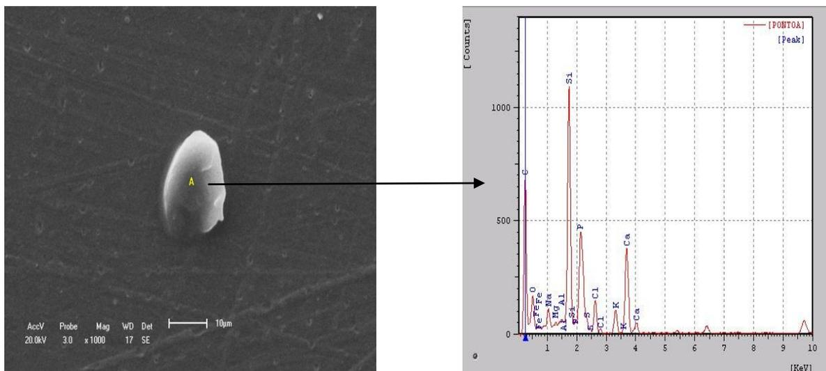
Figura A1: Fotomicrografia obtida por MEV para o filme polimérico PA6 AST1% com a técnica de EDS para avaliar a partícula no ponto A em destaque
