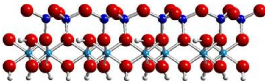
Figura 2.3a – Estruturas cristalinas em camadas Vista lateral de uma camada da caulinita. Folha tetraédrica sobre folha octaédrica (Zeferino, *et. al*, 2010).
