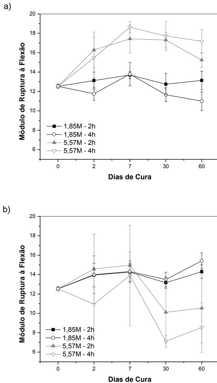
Figura 4.14. Evolução do módulo de ruptura à flexão com o decorrer dos dias de cura, a) cura em temperatura ambiente, b) cura em 60°C
