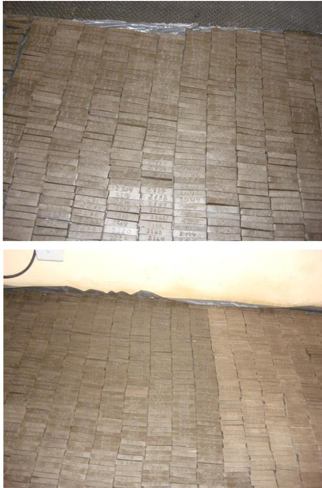
Figura 3. 2 - Corpos de prova após extrusão.
