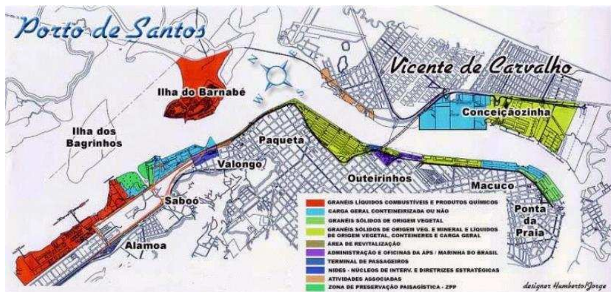
Figura 6.5 – Lay-out da proposta de realocação de Terminais (Fonte: PDZ PS/96; p.150)
