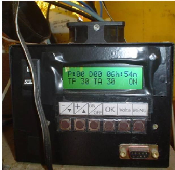
*Figura 2.4-7: Controlador de temperatura do piso – Tratamento TP.*
