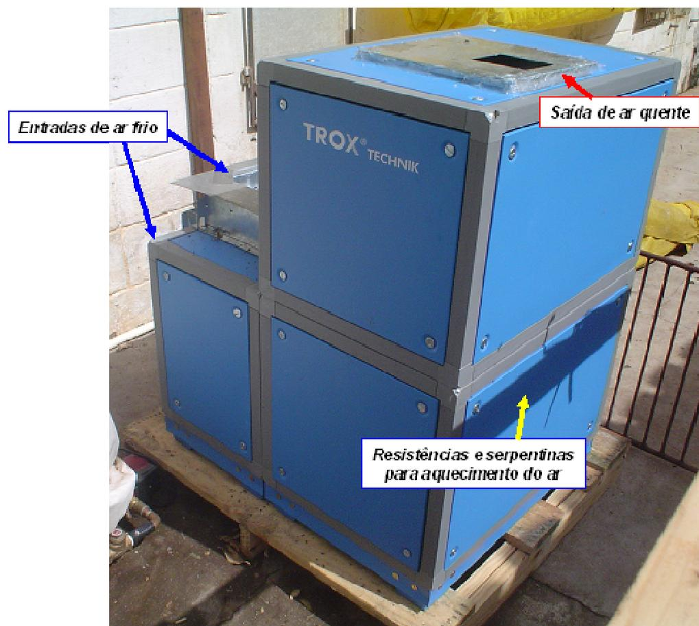
**Figura 2.4-10: Intercambiador comercial utilizado.**
