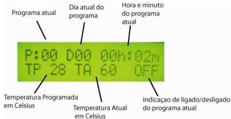
**Figura 2.4-5: Display do controlador do piso aquecido.**
