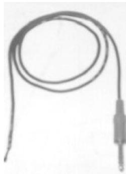
**Figura 2.4-6: Sensor de temperatura utilizado no interior das placas para a atuação do controlador.**
