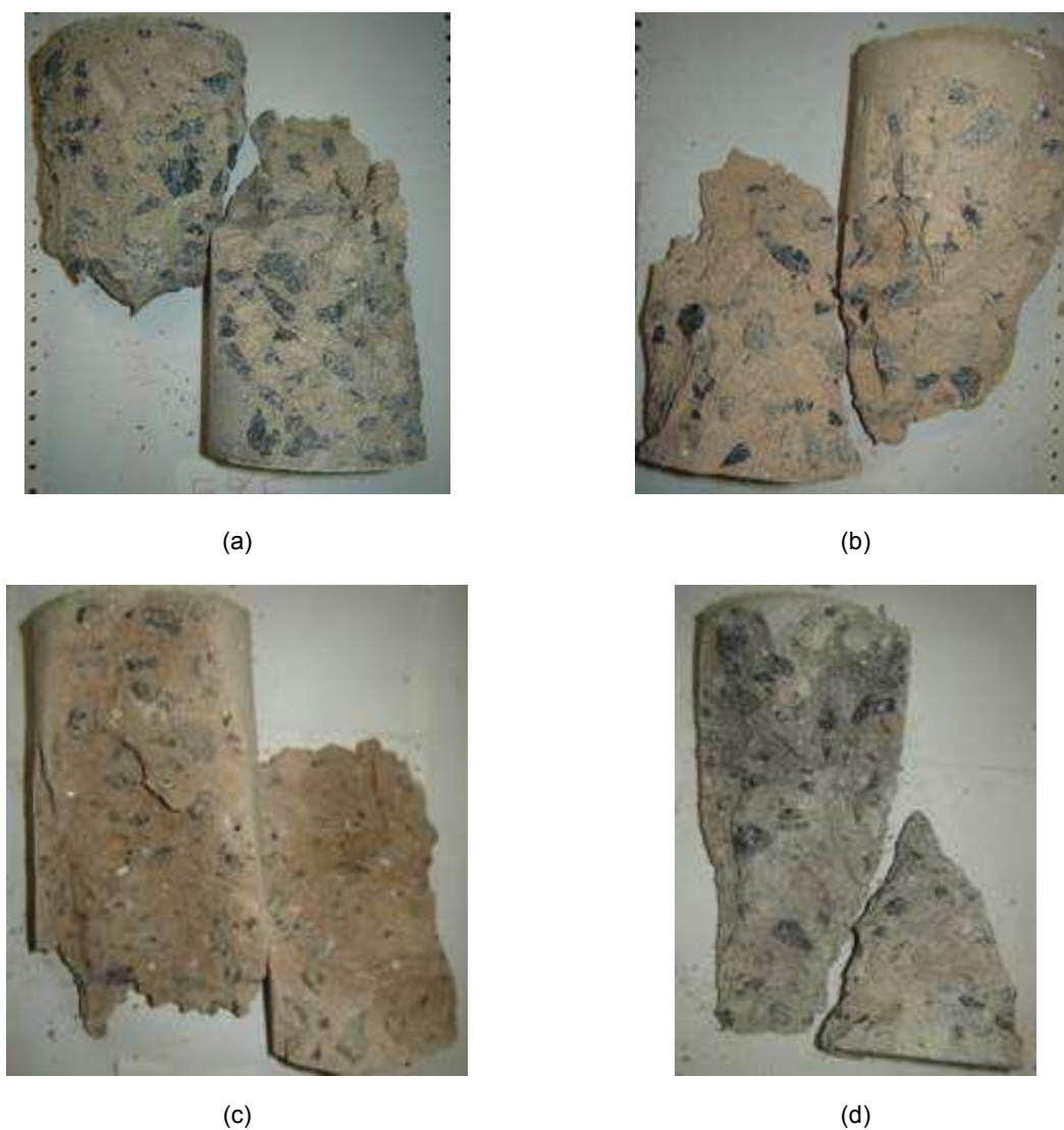
Figura A.20 – Aspecto dos concretos após o rompimento: (a) 5% MF, V_p=0,4 ; (b) 17,5% MN, V_p=0,4 ; (c) 35% MN, V_p=0,5 ; (d) 5% MG, V_p=0,4
