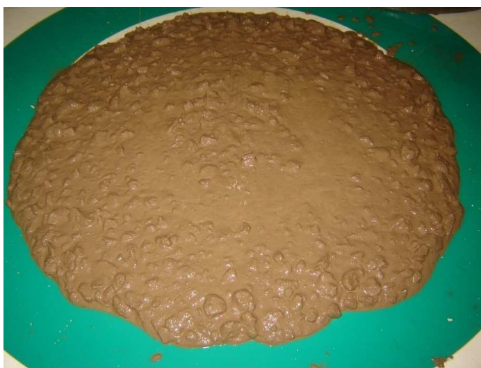
Figura A.19 – Distribuição dos agregados no ensaio de espalhamento (35% N, V_p=0,45 )
