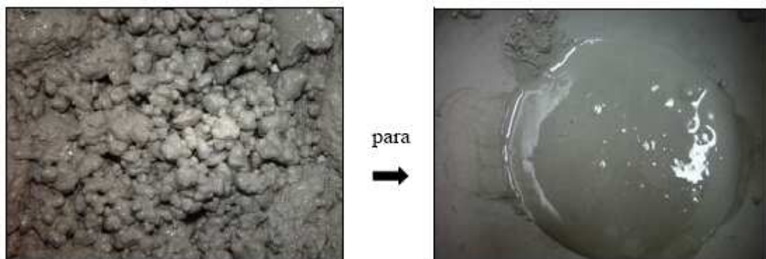
Figura 5 – Diferentes condições de compactidade no ensaio de Demanda de água (FORMAGINI, 2005)
