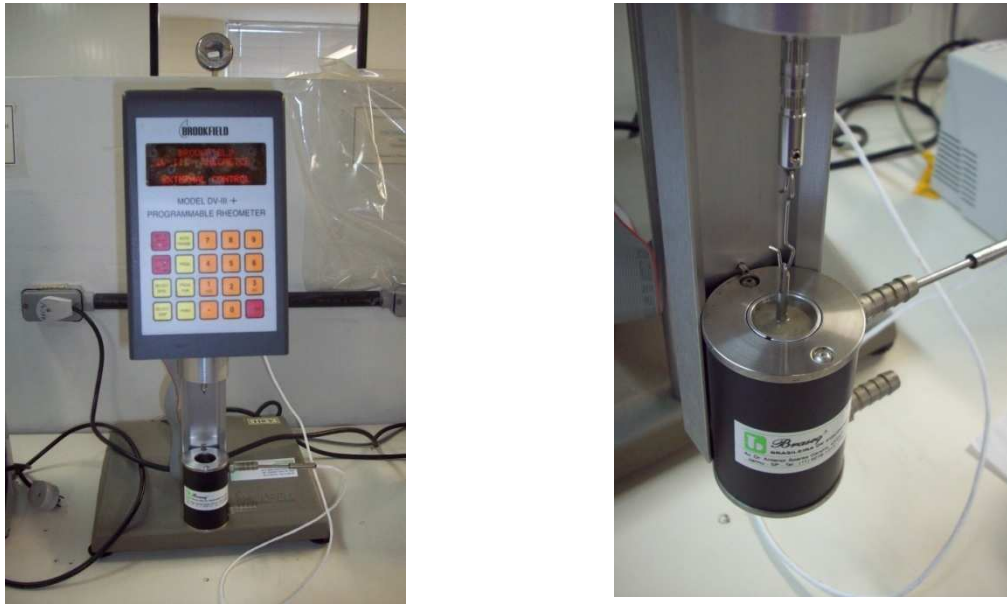
Figura 9 – Ensaio de reologia das pastas
