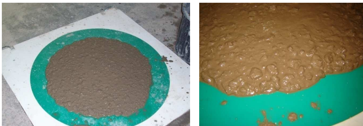
Figura 47 – Distribuição dos agregados no ensaio de espalhamento – ausência de segregação
