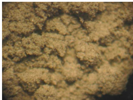
Figura 13 – Imagem do cimento obtida através de lupa (35x)
