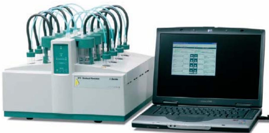
Figura 23 - Rancimat para biodiesel - Metrohm 873 -
