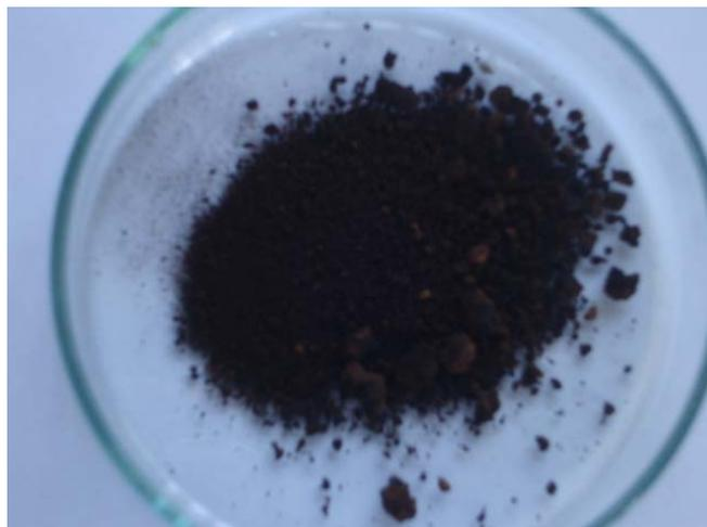
FIGURA 30 – Produto da eletrolise do LCC técnico eletrolisado no eletrólito metanol mais cloreto de sódio (LSAL)
