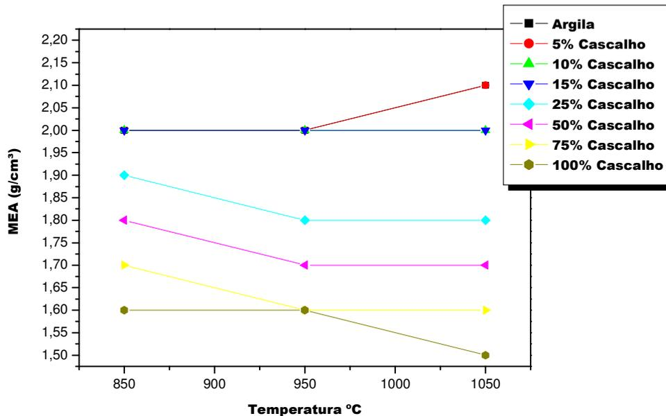
**Figura 4.10 – Resultados do ensaio de Massa Específica Aparente.**
