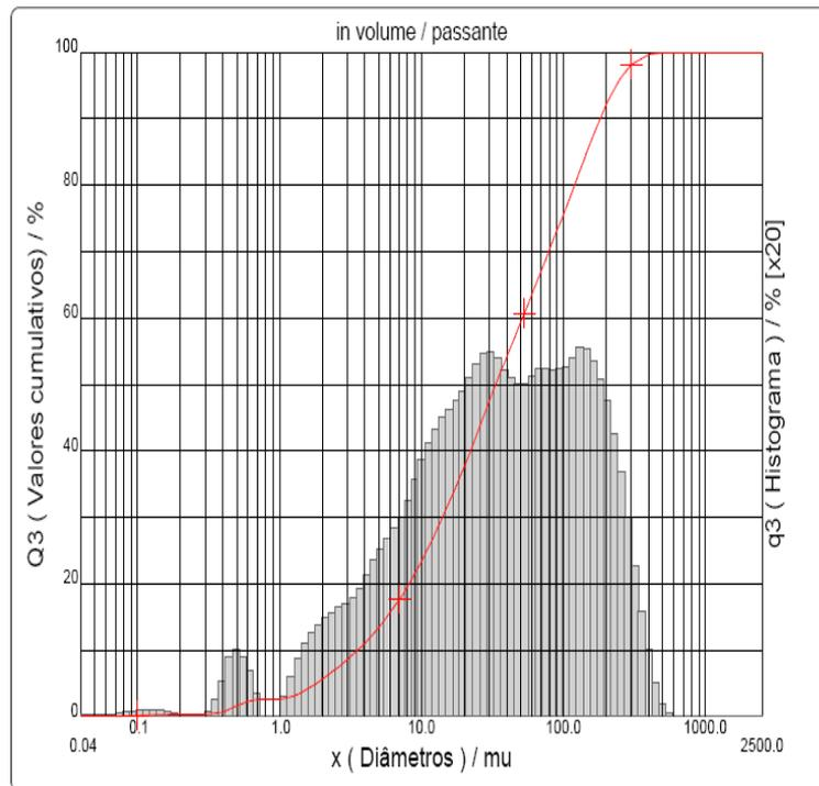
**Figura 4.7 – Curva granulométrica do Cascalho de Perfuração.**
