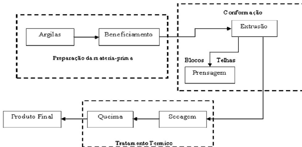
**Figura 2.3 – Etapas Principais do processo de fabricação.**
