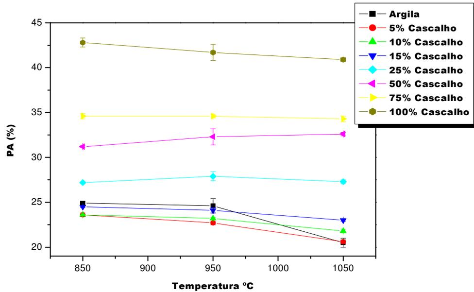
**Figura 4.11 – Resultados do ensaio de Porosidade Aparente.**
