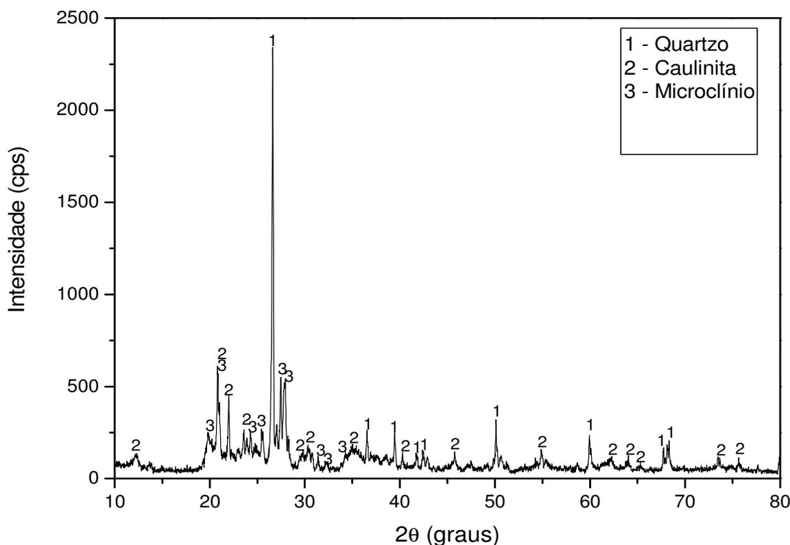
**Figura 4.1 – Difratograma de raios-X da Argila.**
