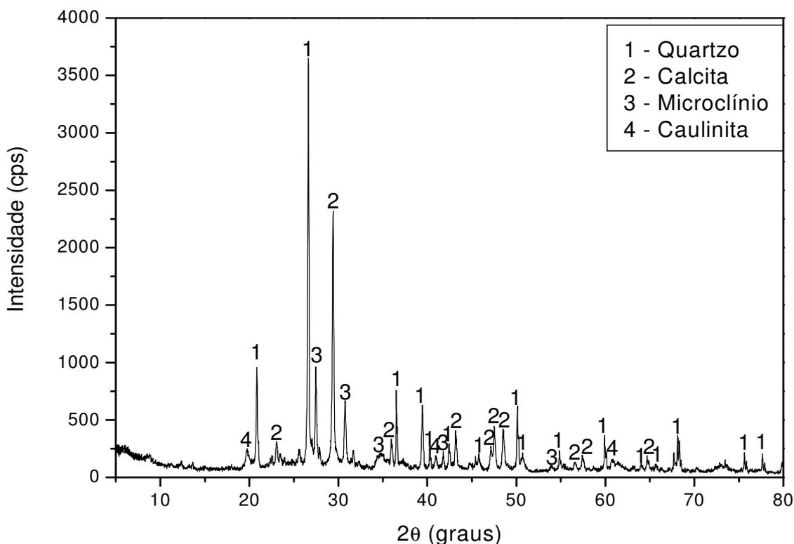
**Figura 4.2 – Difratograma de raios-X do Cascalho de Perfuração.**
