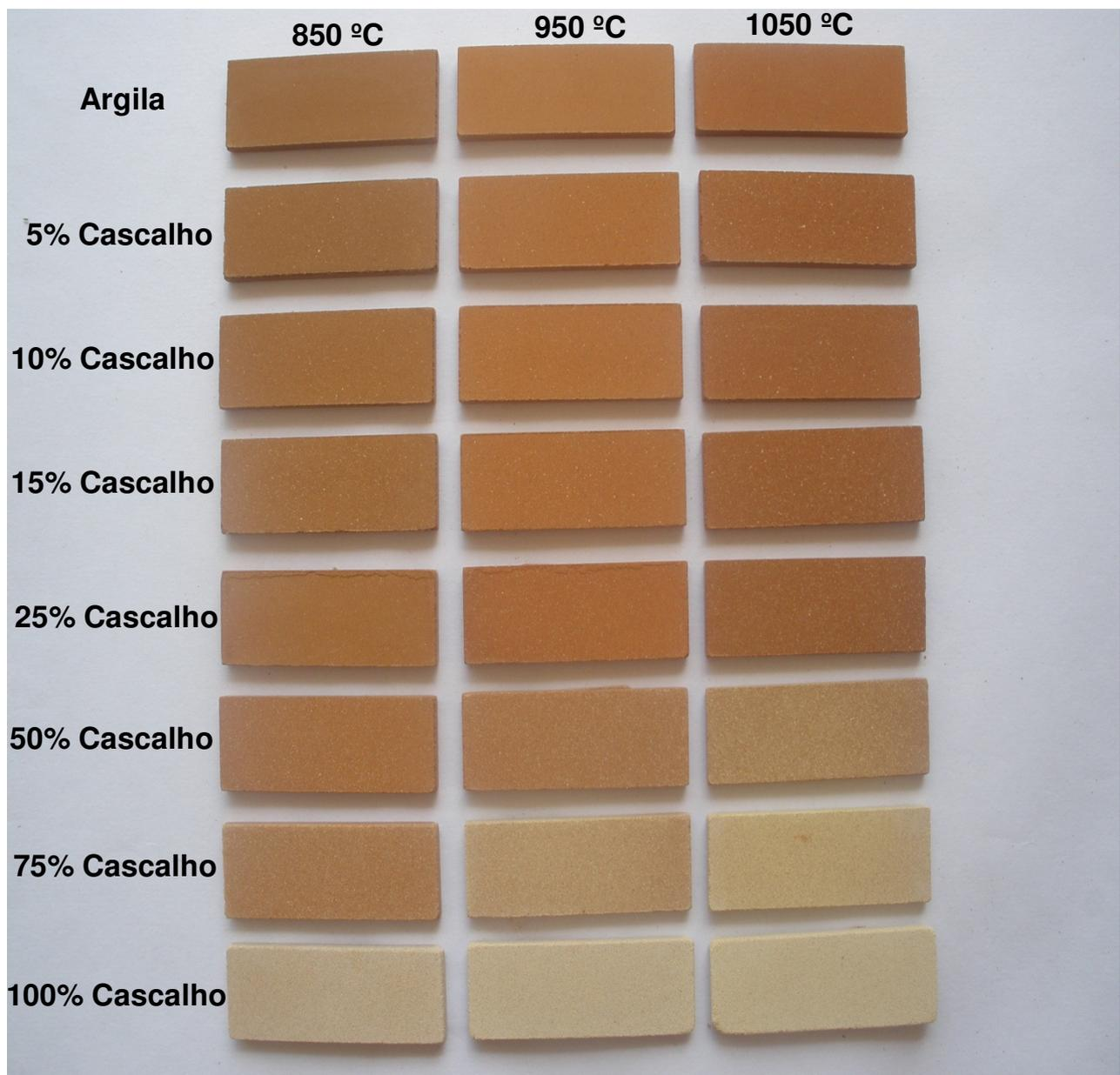
Figura 4.21 – Resultado do Ensaio de Cor.
