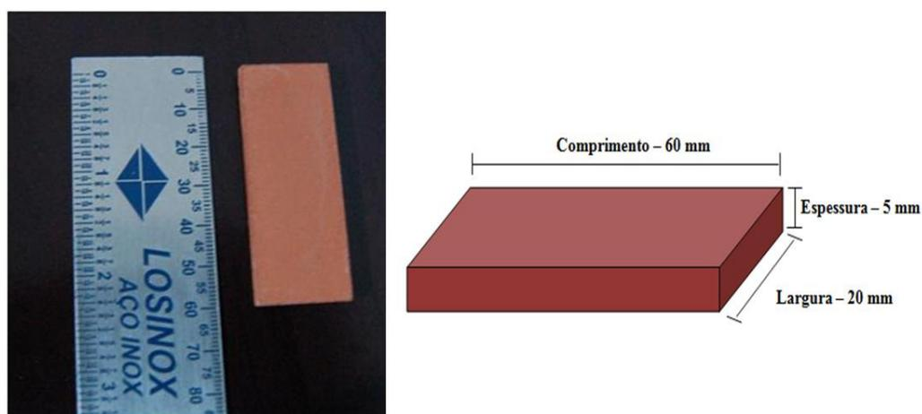
**Figura 3.5 – Dimensões do corpo de prova.**
