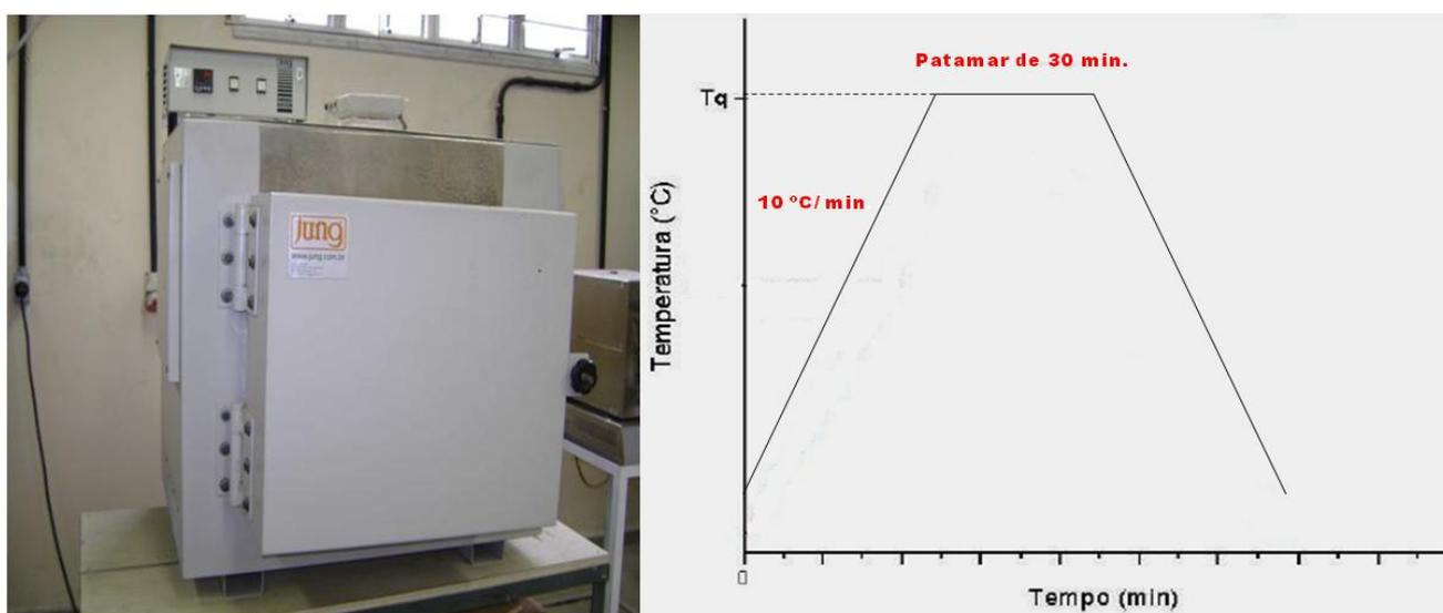
**Figura 3.6 – Forno elétrico e Ciclo térmico**
