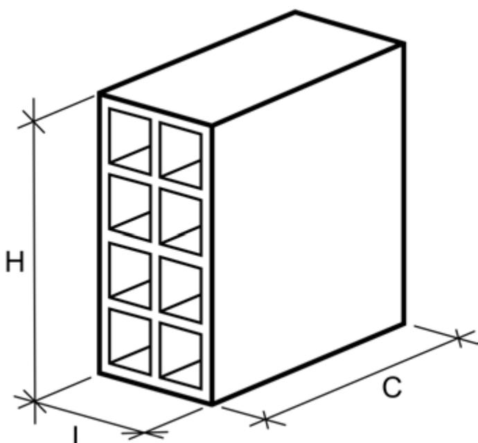
**Bloco cerâmico de vedação com furos na horizontal**
