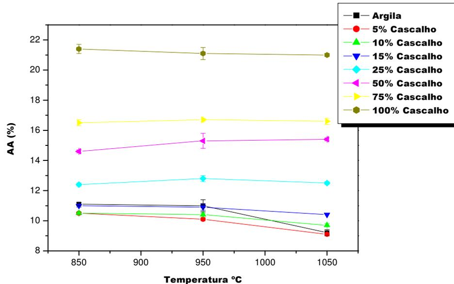
**Figura 4.8 – Resultados do ensaio de Absorção de Água.**
